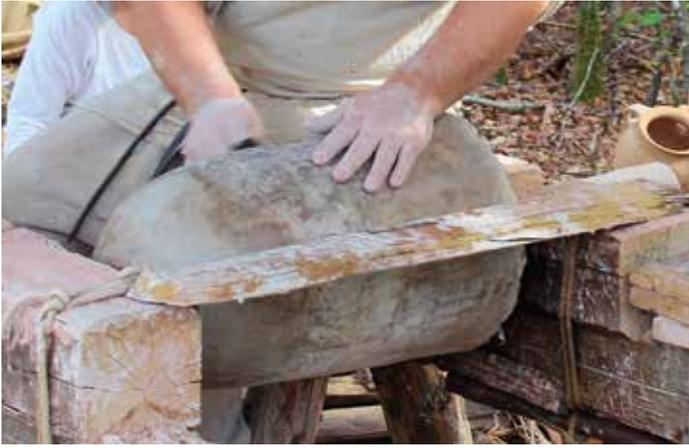
Abb. 10: Mit einer feinen Lehmischung, die nur aus Ton und Kuhmist besteht, wird der Kern geglättet und poliert, denn diese Oberfläche ist verantwortlich für die Gussoberfläche der Innenseite der Glocke.
