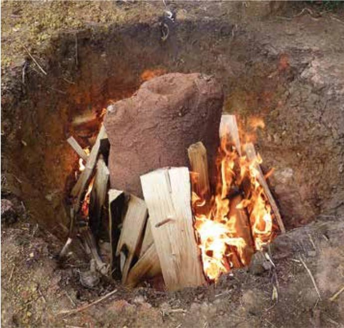
Abb. 21: Die noch grüne Form in der Grube am Beginn des Brandes. Zu erkennen ist noch das Ende eines Entlüftungskanals aus Wachs.
