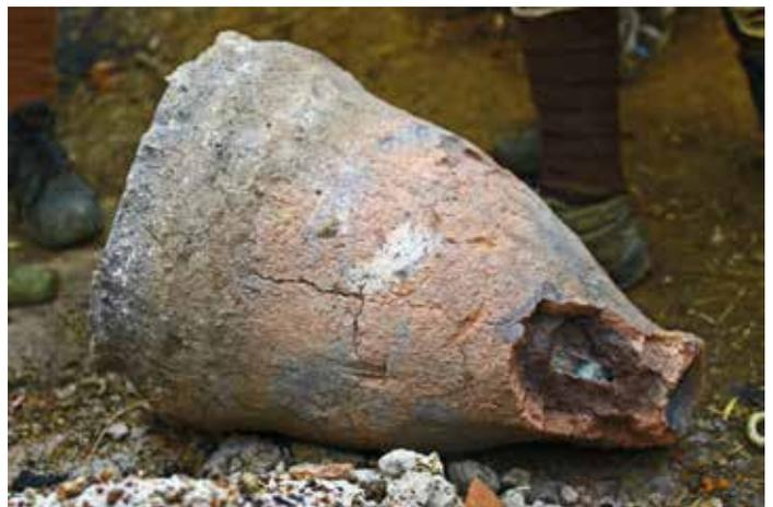
Abb. 28: Die Form nach dem Guss. Theophilus weist an, die Form gleich nach dem Guss auszugraben und den Kern zu entfernen, weil ansonsten die Glocke reißen könnte. Deutlich zu sehen ist die fehlende Krone.
