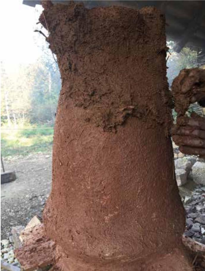
Abb. 19: Alle weiteren Schichten bestehen aus demselben Material wie der Kern. Hier zu sehen ist die dritte Lehmschicht. Besonders deutlich kann man hier die Strohhalme des Formlehms erkennen.
