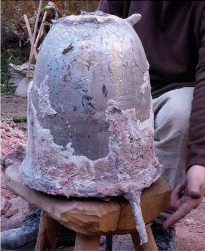
Abb. 29: Auf diesem Bild ist der nicht ordentlich verschlossene Wachsablaufkanal zu erkennen, der während des Gusses ausgelaufen ist.
