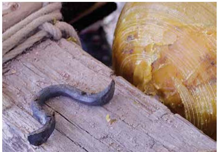
Abb. 16: Der Aufhänger für den Klöppel wird in das Wachsmodell der Glocke einmodelliert, sodass er später, von Metall umflossen, innerhalb der Metallwandung sitzt.
