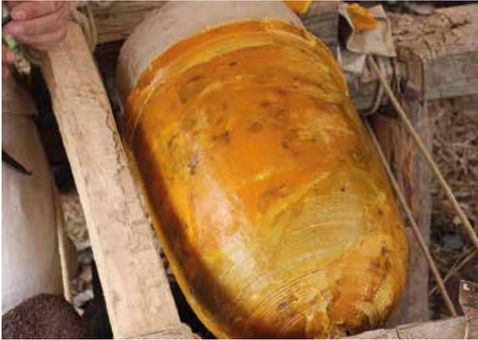
Abb. 12: Nachdem alle Wachsplatten aufgelegt sind, muss noch der Schlagring modelliert werden.
