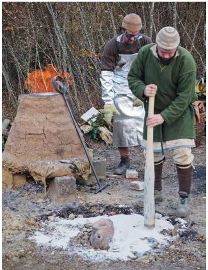
Abb. 25: Rund um die gebrannte Form wird in der Grube mit Sand Erde verdichtet, sodass die Form während des Gusses nicht reißt. Im Hintergrund der Schmelzofen.
