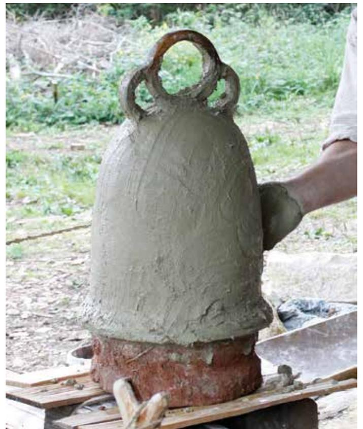
Abb. 18: Die erste Schicht besteht aus einer besonders feinen Mischung zu je einem Teil aus frischem Ton, feinem Quarzsand und Kuhmist.
