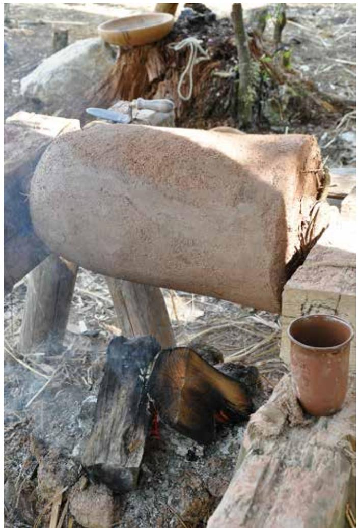
Abb. 8: Kern beim Trocknen über einem leichten Feuer ohne große Flammen. Bei dieser Methode ist Sorgfalt geboten, da sie zu unerwünschten Ergebnissen führen kann. Der Formlehm fühlt sich oberflächlich trocken an, er ist jedoch aufgrund des Kapillarbruchs im Material unterhalb der Oberfläche noch feucht. Besser ist das langsame Trocknen an einem luftigen Ort.
