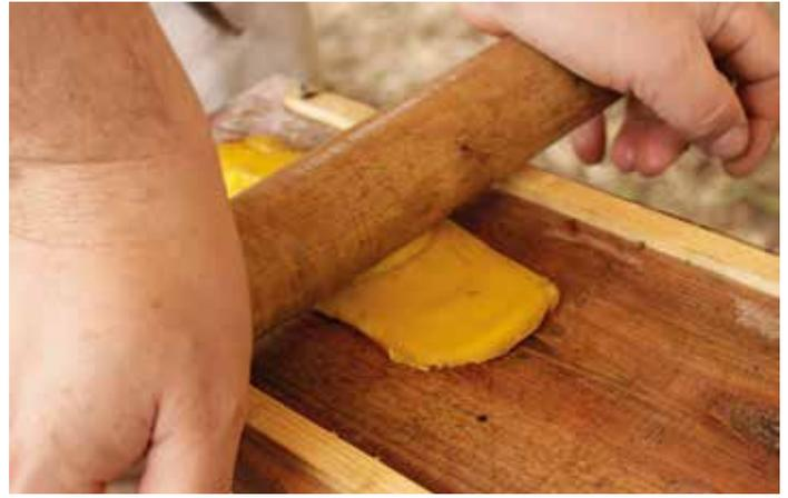
Abb. 11: Auswalzen der Wachsplatten nach Theophilus' Vorschrift. Die Stärke der Leisten bestimmen die Wandstärke der späteren Glocke. Hier sind die Leisten 6,5 mm stark. Das Brett ist angefeuchtet, um ein Ankleben des Waxes zu verhindern.
