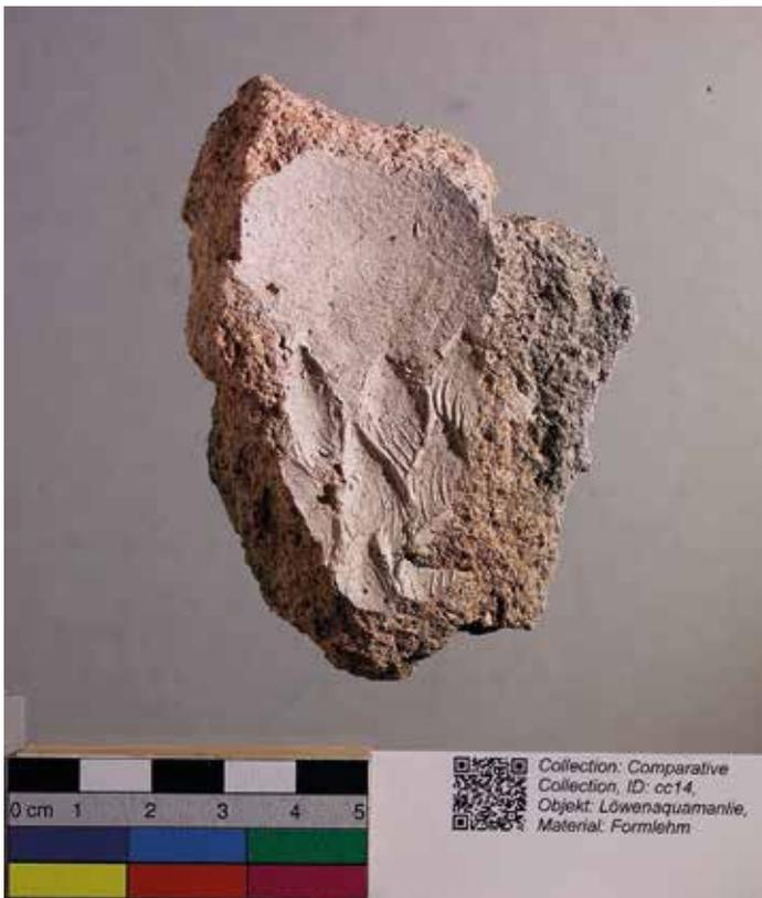
Abb. 4: Abbildung einer rekonstruierten Gussform für ein Aquamanile des 13. Jahrhunderts. Der Formlehm wurde nach Methode 2 aus Bild 3 aufgetragen. Die Abbildungsgenauigkeit ist sehr gut, obwohl der grob gemagerte Formlehm in nur einer Schicht aufgetragen wurde.
