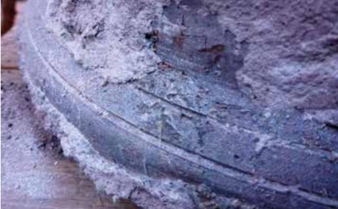
Abb. 30: Die Gussoberfläche der Glocke ist sehr gut gelungen. Hier ist die Verzierung des Schlagrings zu sehen.
