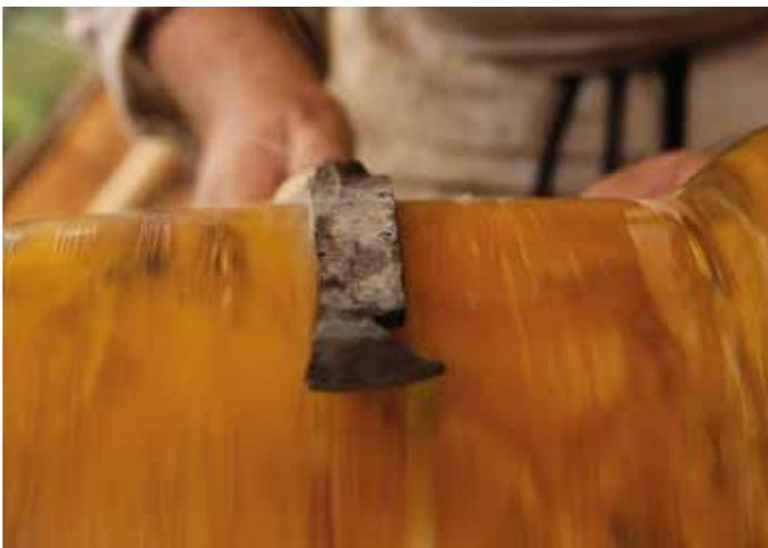
Abb. 14: Der fertige Schlagring ist hier bereits zu erkennen. Das heiße Eisen ist für Wachs die bessere Bearbeitungsmethode, da es die Materialstärke nicht vermindert, sondern das Wachs nur verteilt.
