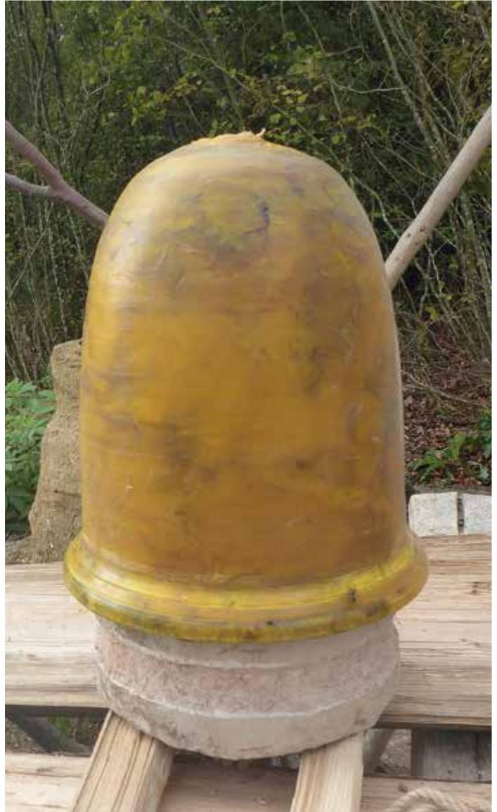
Abb. 15: Um die Krone zu modellieren, wird das Modell aus der Drehlade genommen und nun senkrecht auf eine Arbeitsfläche gestellt. Die umlaufende Nut am Kern verbessert den Zusammenhalt zwischen Kern und Formmantel.
