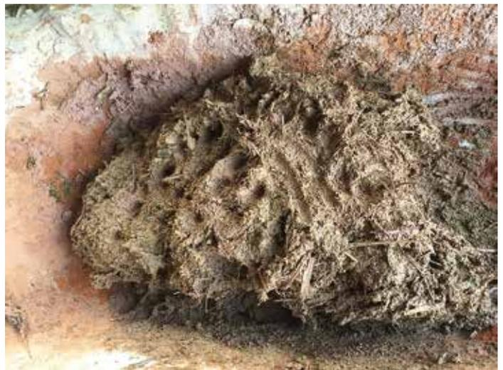
Abb. 2: Fertig gemischter Formlehm für den Formmantel bzw. den Kern. Er besteht aus Ton, gebranntem und gemahlenem Tonscherben, Kuhmist und Stroh.
