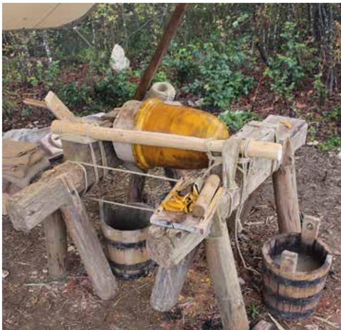
Abb. 7: Funktionsrekonstruktion einer Drehlade. Anstatt der Bohlenwände, die Theophilus vorschreibt, wurden zwei Böcke verwendet, um die Lager für die Spindel zu bilden. Hier zu sehen ist die Spindel samt Kern und Wachsmo-
