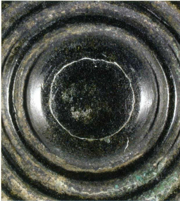
Abb. 4: Detail der Punzbahn 2 mit Oberflächenriss. Foto: S. Werner.
