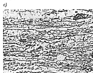
Bild 4.53 Entstehung des Rekristallisationsgefüges. (Beispiel: Stahl C 10; 90% kaltgewalzt). a) Walzstruktur, b) Entstehung neuer Kristallite im deformierten Gefüge, c) fortgeschrittene Rekristallisation
