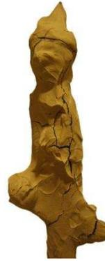
Figure 002 : 2006 : Vue du réseau de fissures quand la barbotine est sèche.
