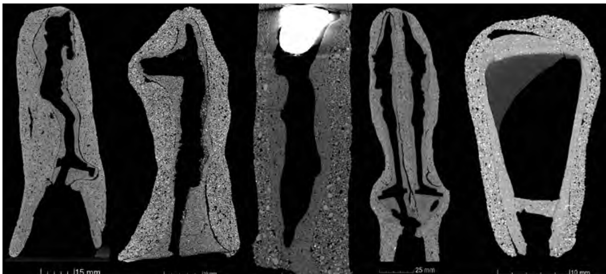
Abb. 7.38: Beispiele für zweilagige Formmantelschichten. Von links: QH207/42 (Kat. 4.5); 207/46 (Kat. 4.9); 207/48 (Kat. 4.11); 207/45 (Kat. 4.8); 207/56c (Kat. 4.18) (Abb.: F. Willer/D. Meinel).
