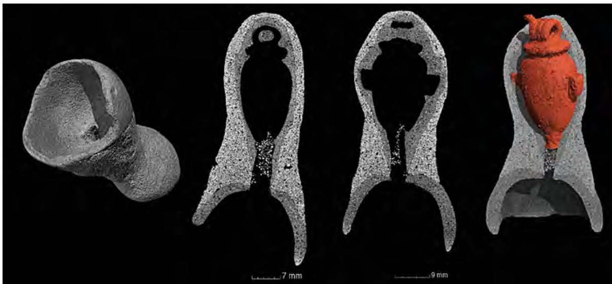
Abb. 7.40: Verschiedene Ansichten und Schnittbilder der Gussform für ein Amulett (QH 207/47; Kat. 4.10). Die innere feine Formmantelschicht ist auch im Bereich des Eingusskanals sowie Eingusstrichters vorhanden (Abb.: D. Meinel).
