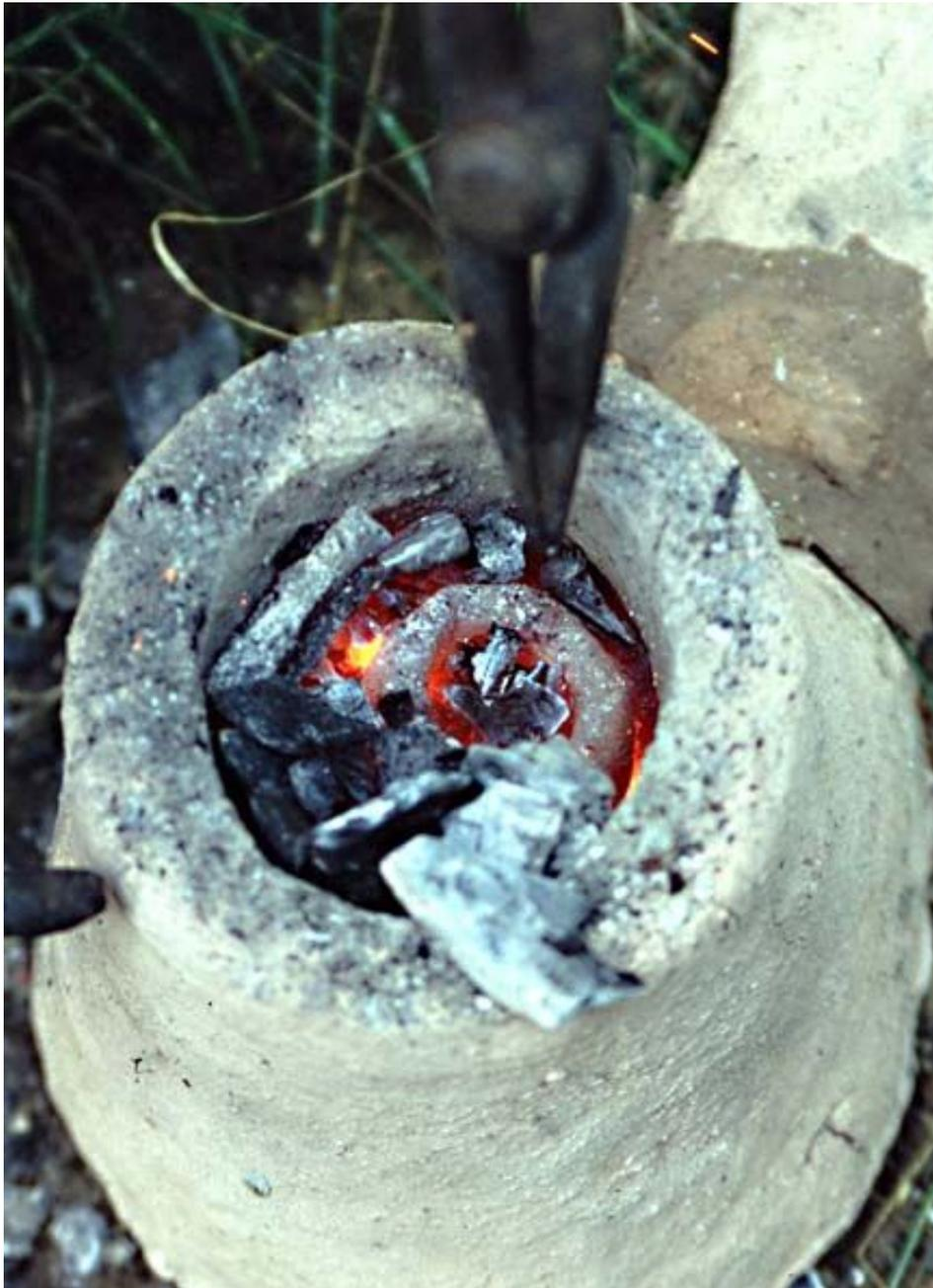
Abbildung 6: Einsetzen des Tiegels in die obere Ofenkammer.
