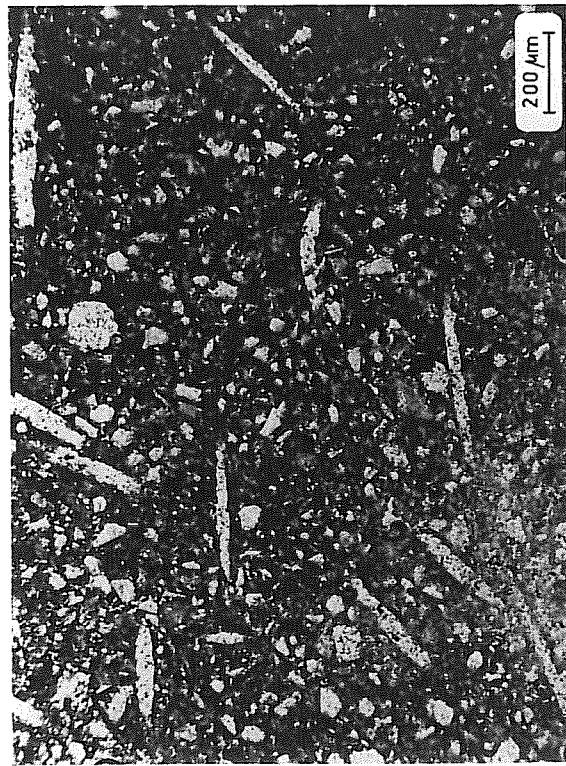
Abb. 25 Mikrofoto der Schlichteschicht der Gußformen mit Poren von Haaren (Probe 1684)
