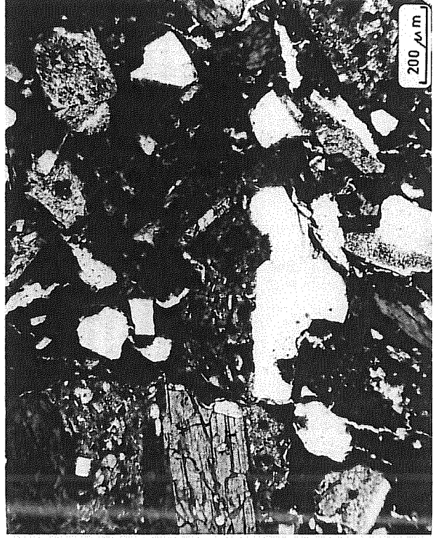
Abb. 32 Mikrofoto eines Gußkerns aus Kythera, grober innerer Kern (Probe 2511) mit Bruchstücken von vulkanischem Gestein
