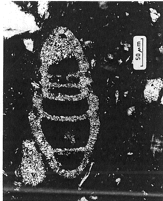
Abb. 36 Mikrofoto einer Foraminifere in der mittleren gemischten Schicht einer Plattengußform (Probe 1686)
