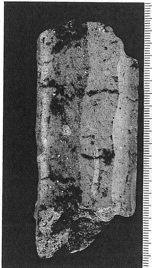
Farbtafel 2,2 Querschnitt einer Form für Bronze (Plattengußform) aus drei Schichten von unterschiedlichem Ton. Die auf das Wachmodell aufgetragene erste Schlichteschicht ist unten
