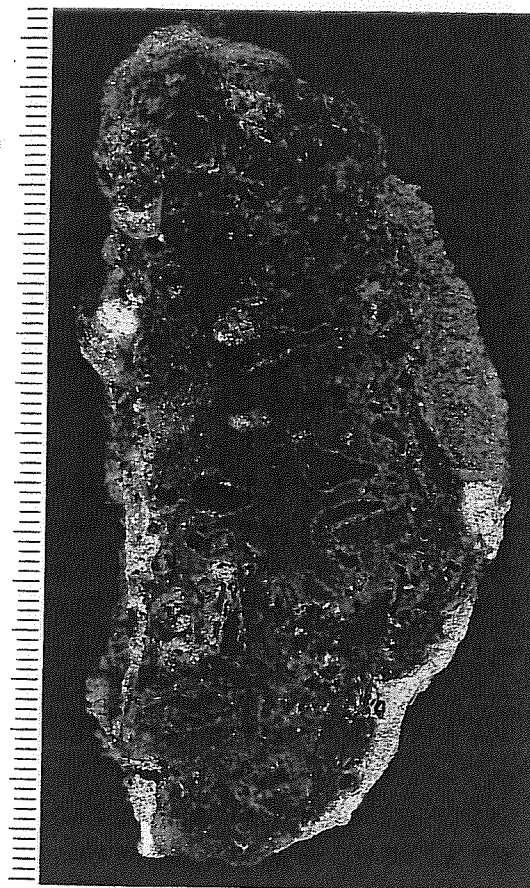
Farbtafel 3.2 Querschnitt einer Eisenschmiedeschlacke (Probe 19/82, FO: erster Abhub der Grabung, Phidiaswerkstatt, Olympia)
