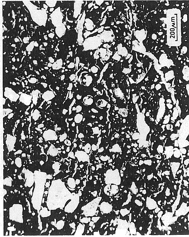
Abb. 19 Mikrofoto eines Tiegelfragments mit runden Poren von Haarquerschnitten (Probe 1677)
