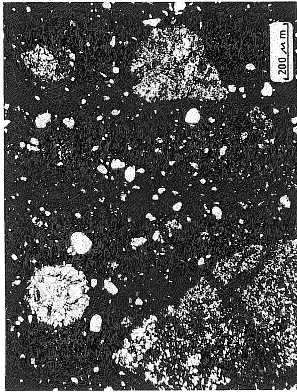
Abb. 18 Mikrofoto eines kleinen Versuchstiegels aus örtlichem Ton (Probe 1669) nach Erhitzung auf 1050 °C
