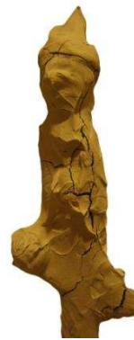
Figure 002 : 2006 : Vue du réseau de fissures quand la barbotine est sèche.
