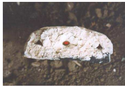
Figure 004 : 2006 : Potée, à cœur rouge, attendant dans la fosse de coulée. Nous avons fait ce choix en pensant minimiser le choc thermique entre la potée et le bronze en fusion.
