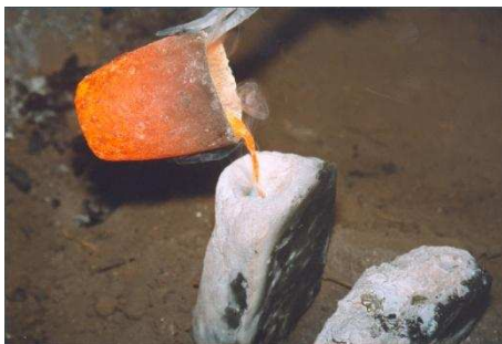
Figure 005 : 2006 : Coulée de bronze en fusion.
