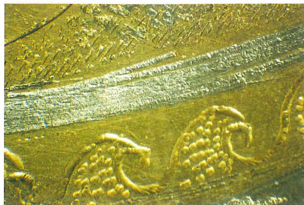
Abb. 1: Diffusionsgebundene Folienvergoldung auf einer parthischen Silberschüssel, J. Paul Getty Museum, 1. Jh. v. Chr. Bildausschnitt ca. 3,3 cm x 5 cm
