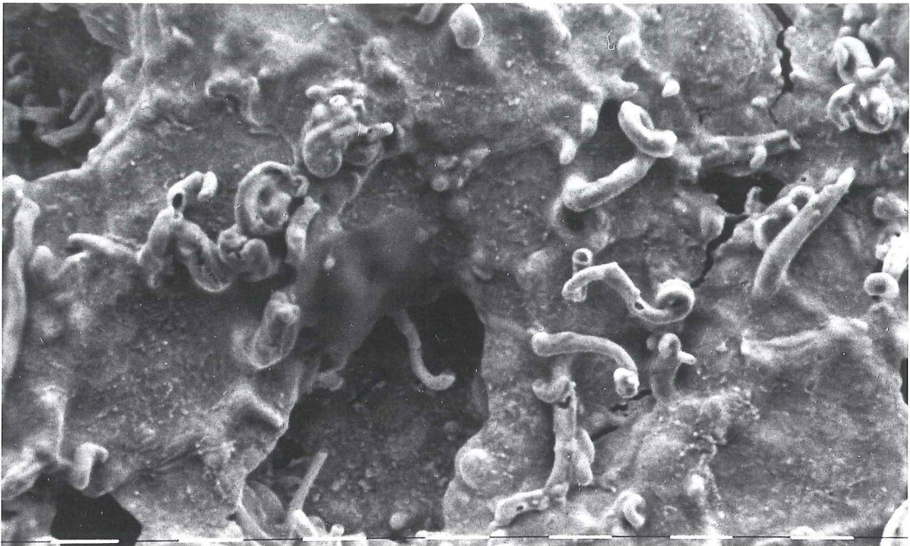
Abb. 23: Detailvergrößerung aus Abb. 20. Poröse Oberfläche einer Feuervergoldungsprobe nach dem Erhitzen vor dem Polieren. Die verformten röhrenartigen Amalgamteilchen entstanden durch das Zerreiben der Amalgampaste bei ihrer Herstellung. Rasterelektronenmikroskop, Sekundärelektronenbild. Ein weißer Balken entspricht 10 \mu\text{m} .
