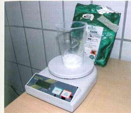
Das Kaliumpyrosulfit wird genau abgewogen.
