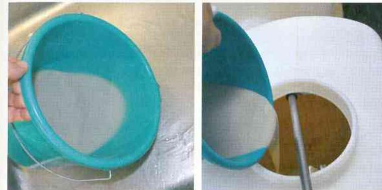
*Nach 4–6 Stunden wird das überstehende Wasser entfernt und das gelöste Bentonit in das Fass angerührt.*
