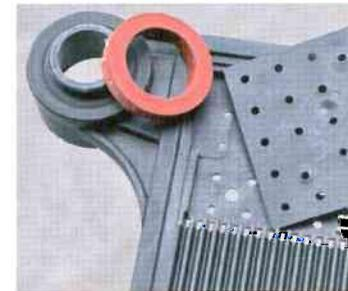
*Kritische Stellen der Reinigung sind Dichtungen, Verschraubungen und feine Kanäle des Filters.*
