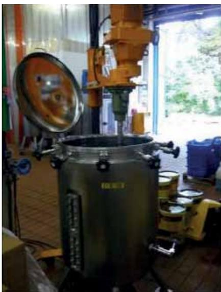
Abb. 5: Herstellapparatur für Versuchssirupe bestehend aus Edelstahlbehälter, Rührwerk und Blattührer (Technikum, Südzucker AG)
